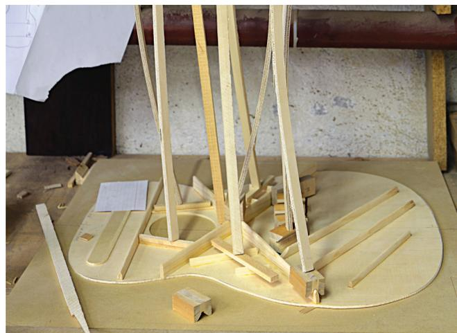
Für alle Verleimungen verwende ich spezielle Klebstoffe die für den Instrumentenbau entwickelt wurden. Knochenleim wird vor allem verwendet um den Hals-Korpusübergang zu verbinden.
